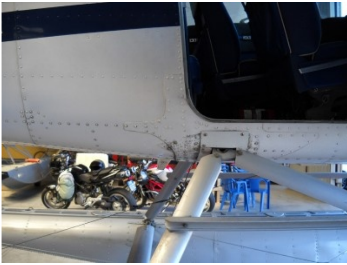
Como – C172P idro I-BISB – dettaglio del fissaggio galleggianti © Andrea Pasqualiini
